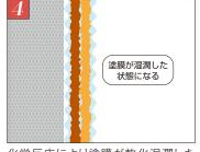
化学反応により塗膜が軟化湿潤した 状態になります。
