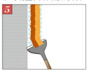
スクレーバー等で剥ぎ取ると湿潤した シート状に回収できます。※刃先が交換 可能な鋭利なスクレーパーを推奨します。
