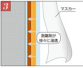
一定時間放置する。剥離剤が徐々に塗膜に浸透していきます。 塗布部にマスカー等で養生するとより効果的です。
